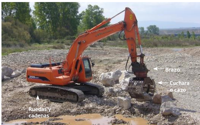
Puntos críticos a examinar y aplicar limpieza exhaustivamente en maquinaria de trabajos en cauce.
