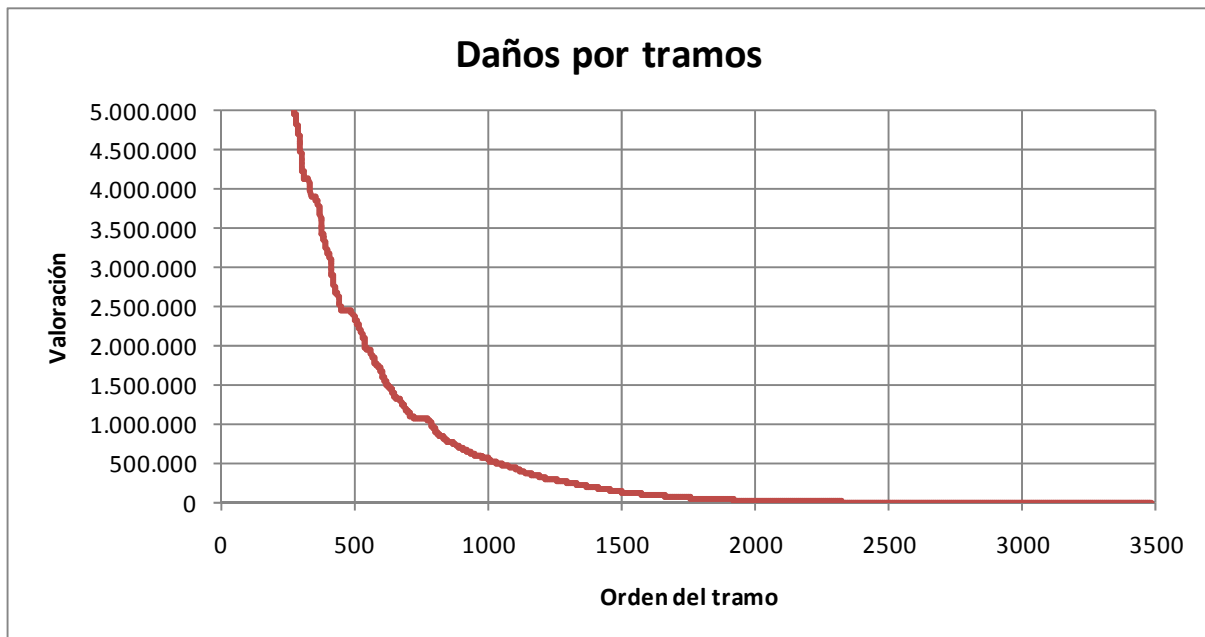
Fig. 6. Tramos clasificados por valoración de daños (zoom)
