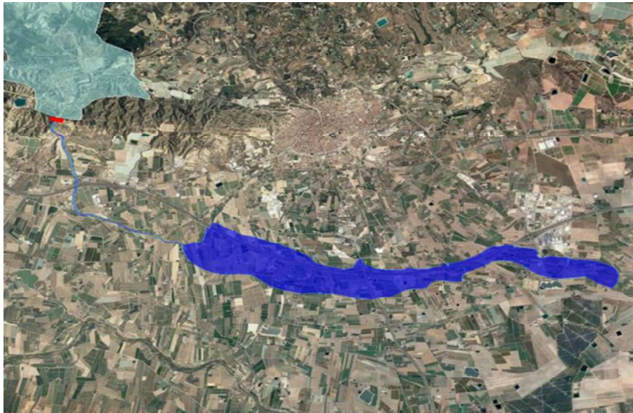
Superficie inundada por la rambla de Lebor en cada episodio de avenida. (411 ha)
