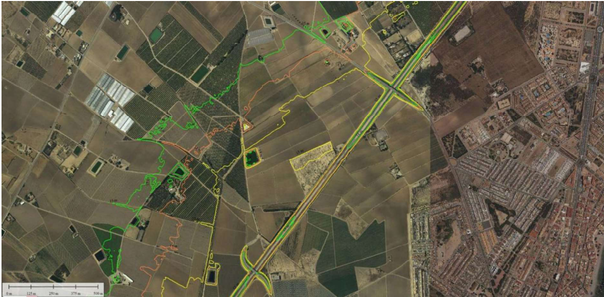
FIGURA 3. Líneas de nivel a cota 13, 14 y 15 metros
